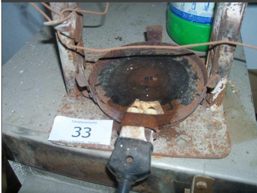
Resistenza di piastra riscaldante da laboratorio in amianto friabile
